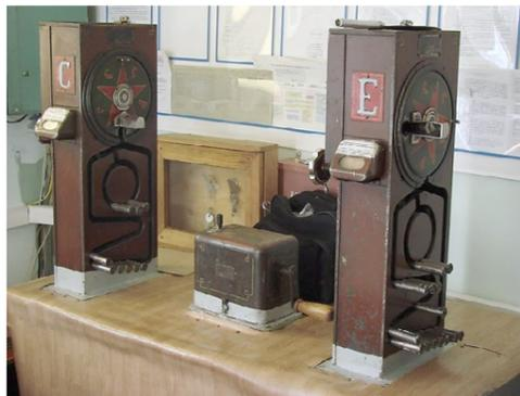
Рис. 1 Жезловый аппарат Д.С.Трегера
